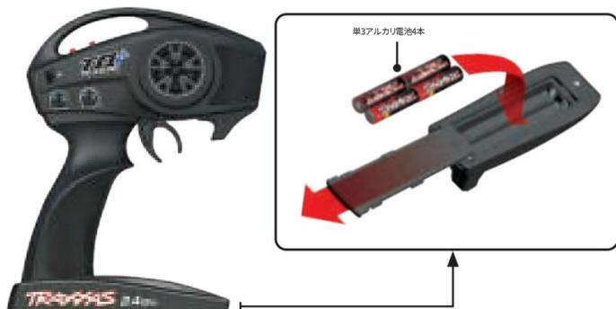
1. タブを押してドアをスライドさせて開き、電池室のドアを取り外します。
