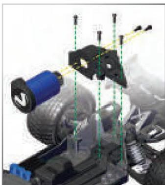
ギアの噛み合いを設定するには、右の表を参照して、選択したモーターピニオン（18T～25T）とスパーギアサイズ（4T）に対応するギアカバー（AI）のネジ位置を確認してください。モーター/ギアカバーから2本のネジを外し、対応する位置に取り付けます。モーター/ギアカバーアセンブリをシャーシに取り付けます。
